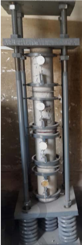
Fig. 7. The creep test apparatus
